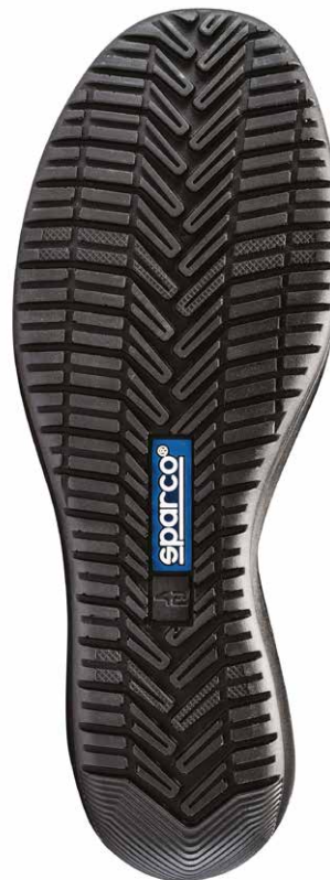
SEMELLE EXTERIEURE FLATGRIP en PU Bidensité. SRC, antistatique, résistante aux huiles et aux hydrocarbures
